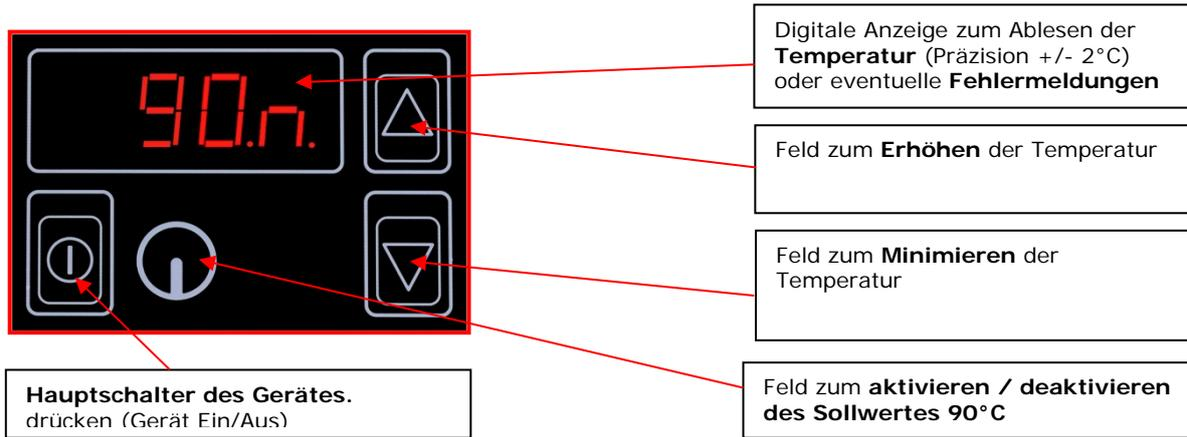
Bei der Aufheizung werden der SOLL-Wert und der IST-Wert in Zeitintervallen abwechselnd angezeigt. Dies wird auch bei Restwärme bis 45°C im ausgeschalteten Zustand weiter angezeigt um Verbrennungen zu vermeiden.
